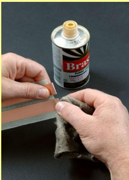
Com um pano ou papel toalha limpar os resíduos de adesivo com limpa metais ou outro solvente como limoneno ou thinner. As lâminas da tesoura também podem ser limpas com estes materiais
