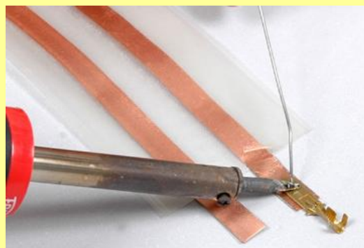
Terminais de crimpagem também podem ser soldados às extremidades
