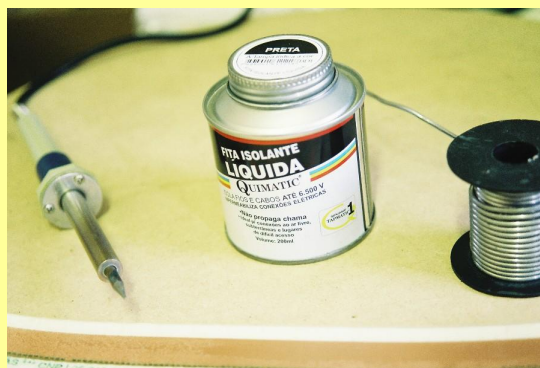
O isolamento da solda pode ser feito com Fita Isolante Líquida 'Quimatic'
